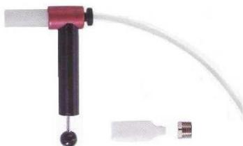
**OIL TEST:** Črpalka za vzorčenje se uporablja za jemanje vzorcev olja iz strojev, opremljena s centralnim sistemom mazanja. Na zahtevo adapterji in steklenice.
